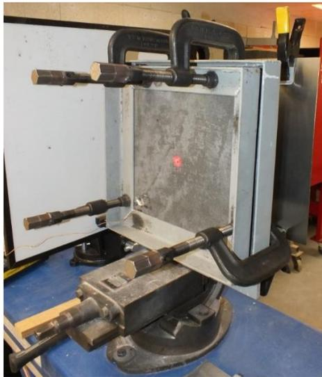
Figure A-4 : Support utilisé pour les essais d'impact des panneaux de BFUP
