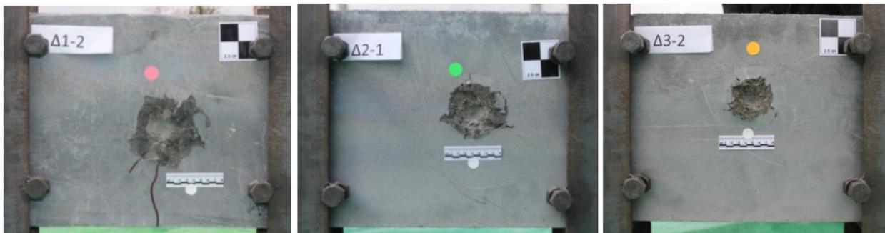
Figure 2-23 : Dommages de panneaux de BFUP de 1, 2 et 3% de fibres respectivement de gauche à droite, avec une épaisseur de 50mm [54]
